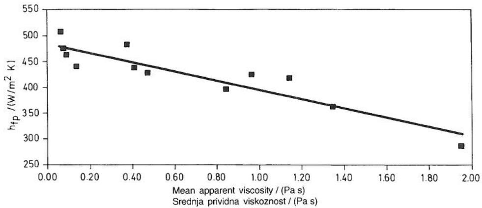
Fig. 2. Estimated values of  $h_{fp}$  vs. fluid mean apparent viscositySlika 2. Odnos između  $h_{fp}$ -vrijednosti i srednje prividne viskoznosti tekućine
